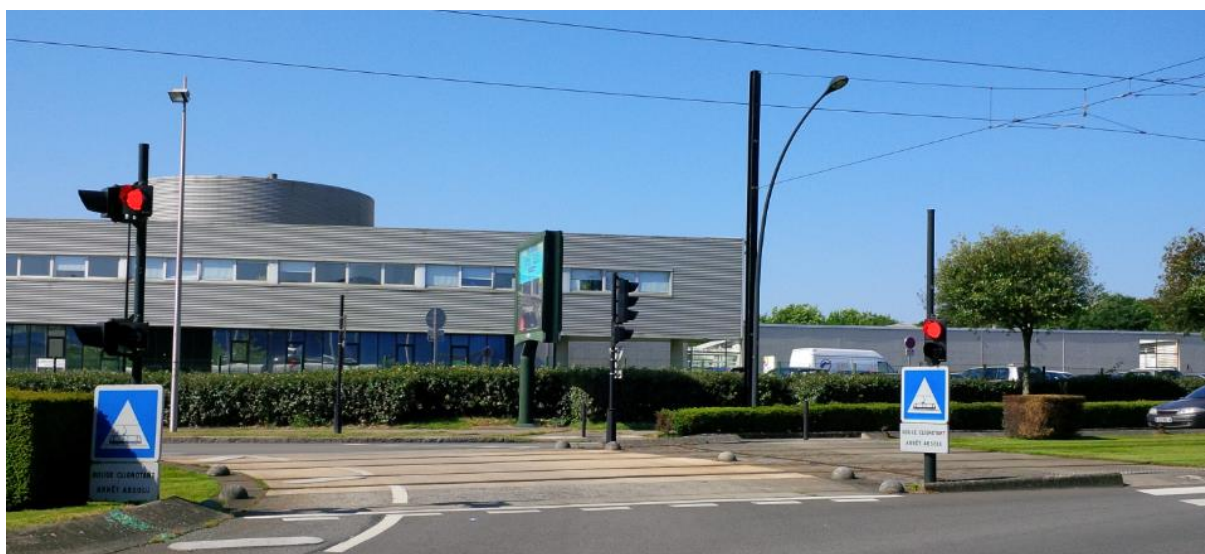
Carrefour équipé de feux rouges clignotants R24 et de panneaux C20c.
