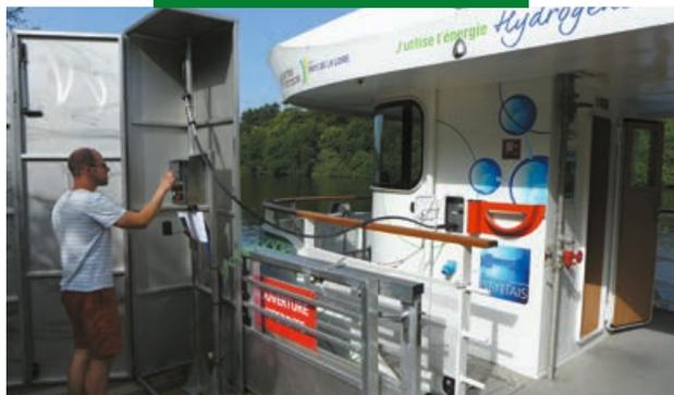
La navette est alimentée en hydrogène sous pression 350 bar directement depuis le ponton.
