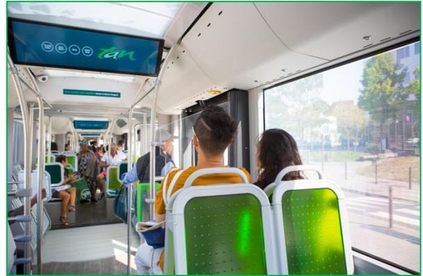
**La structure des sièges** (fournis par l'entreprise italienne RUSPA) : il s'agit du modèle modèle citipro avec prise pour clé usb intégré et dont le dossier est rétroéclairé.
